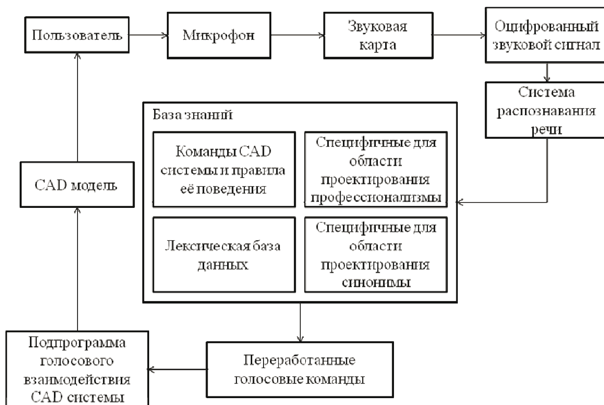
Рисунок 2 – Модель голосового управления САД системой на тривиальном языке
