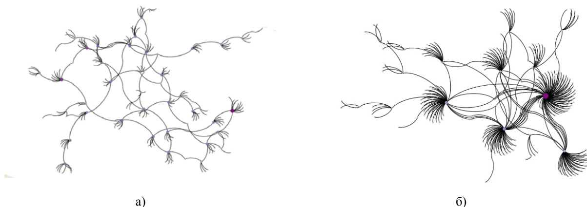
Рисунок 2 – Пример сети, построенной зондированием модельных сетей: (а) – Erdős-Rényi; (б) – Barabási-Albert
