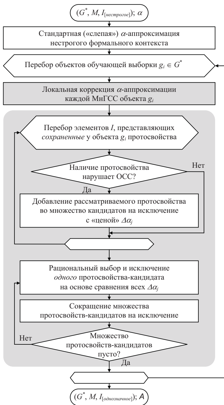
Рисунок 4 – Схема построения рациональной \alpha -аппроксимации нестроого формального контекста ( A - множество реально использованных порогов доверия для аппроксимации различных фрагментов контекста)
