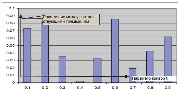
Рисунок 6 – Расстояния между соответствующими точками (мм) на линиях пересечения двух цилиндров в различных CAD-системах (параметр кривой t )
