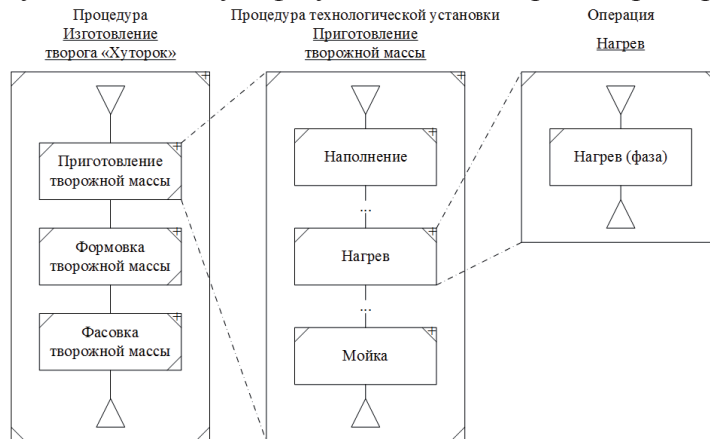
Рисунок 20 - Процедурная модель, выполненная в соответствии с ISA-88.00.02
