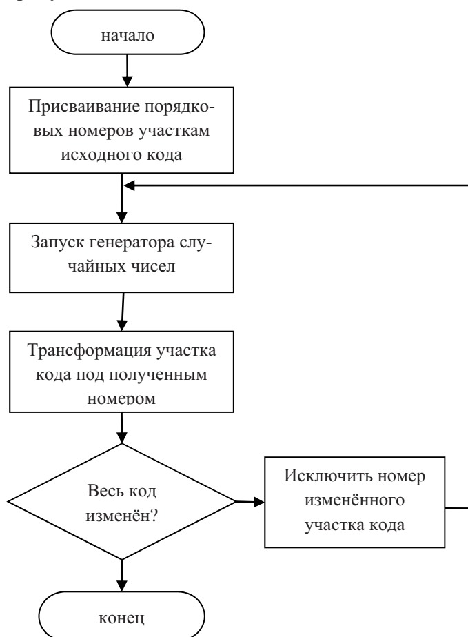
Рисунок 7 - Блок-схема изменённого алгоритма обфускации
