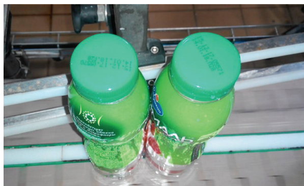
Рисунок 2 – Бутылка с йогуртом с маркированными крышками
