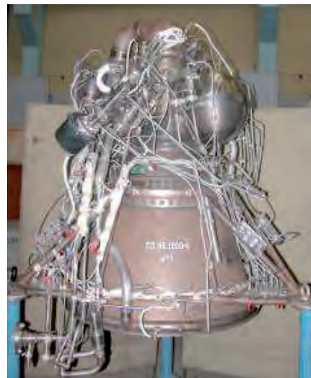
Рисунок 7 – ДУ С5.86.1000 производства КБХиммаш им. А.М. Исаева
