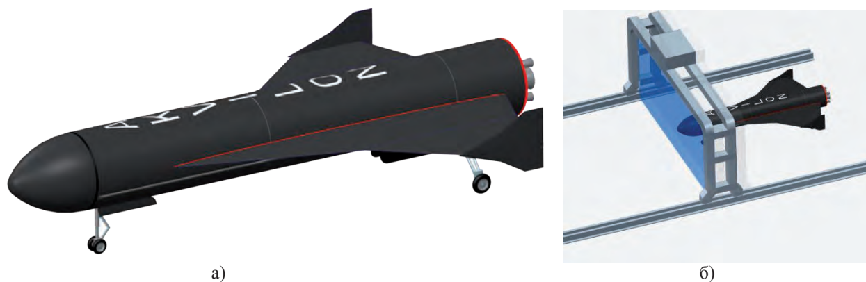
Рисунок 9 – Общий вид возвращаемой первой ступени с жёстким крылом (а) и диагностирование первой ступени с помощью мобильного бесконтактного стенда (б)
