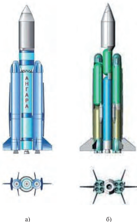
Рисунок 8 – Общий вид РН «Ангара» А3-В с многоразовыми ускорителями «Байкал» (а) и МРКС-1 в конфигурации с двумя возвращаемыми ракетными блоками (б) [13]
