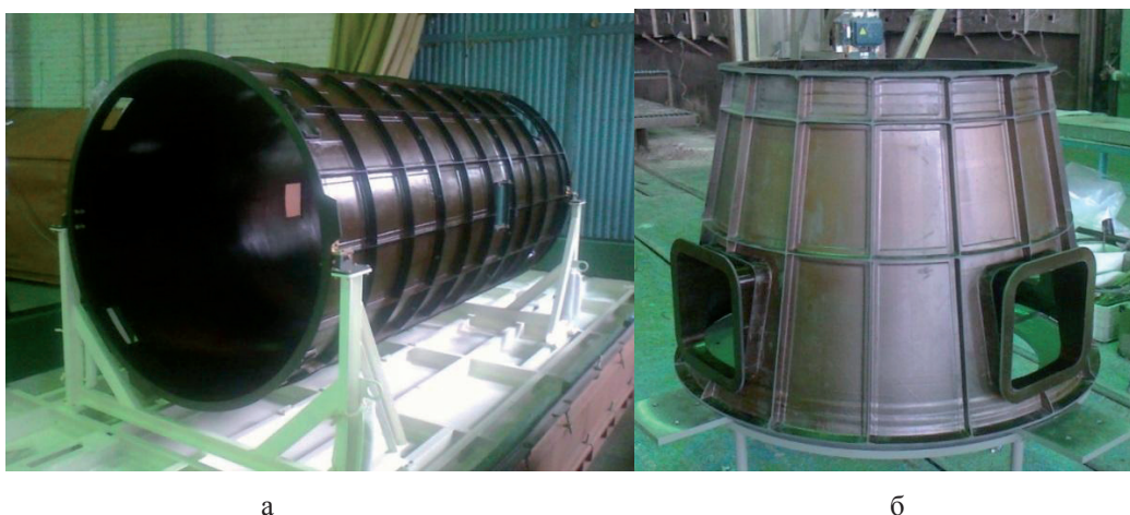
Рисунок 4 – Размеростабильные цилиндрическая (а) и коническая (б) несущие корпусные конструкции космического телескопа оптико-электронного комплекса высокого разрешения
