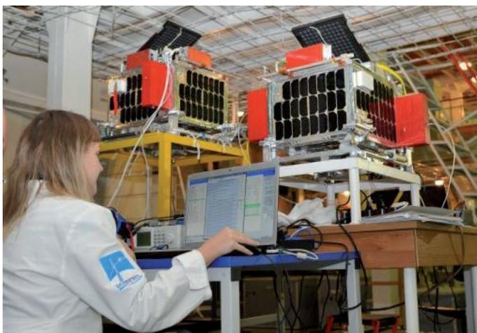
Рисунок 6 – Лётный и технологический образцы МКА «АИСТ» при проведении радиотехнических испытаний
