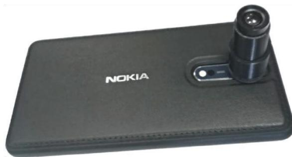
Рисунок 1 – Сверхкомпактный изображающий гиперспектрометр на базе смартфона
