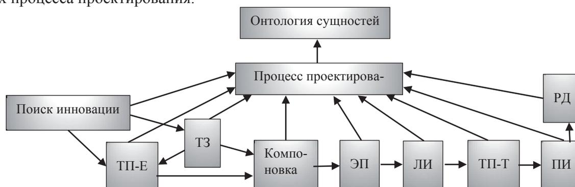
ТП-Е – техническое предложение; ТЗ – техническое задание; ЭП – эскизный проект; ЛИ – лабораторные испытания; ТП-Т – технический проект; ПИ – производственные испытания; РД – рабочая документация.
