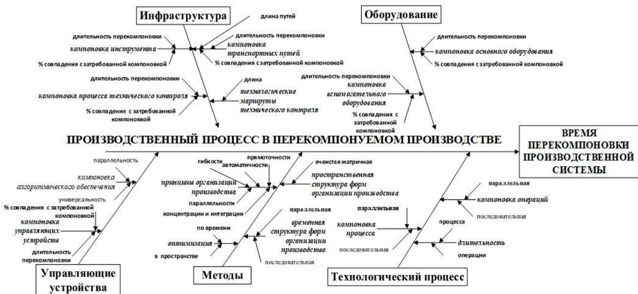
Рисунок 6 – Диаграмма Исикавы факторов, влияющих на скорость перекомпоновок производства
