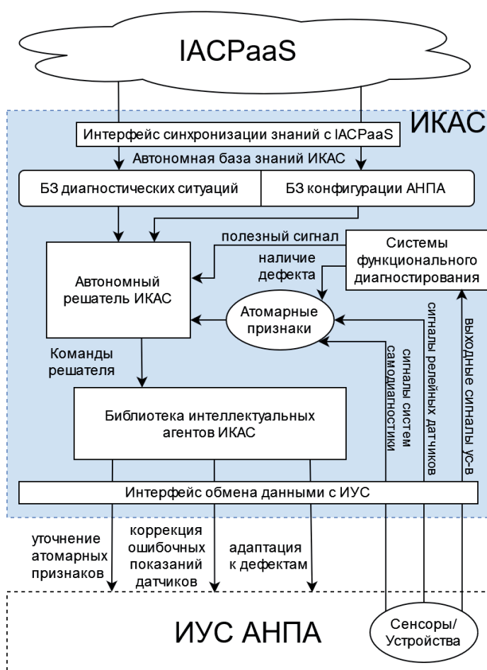
Рисунок 1 – Обобщённая структурная схема работы ИКАС
