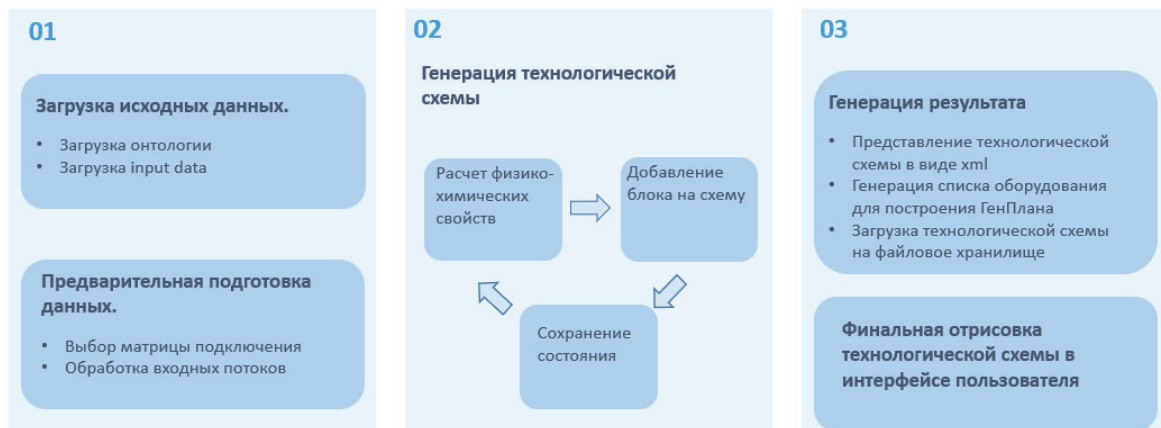
Рисунок 7 – Этапы построения технологической схемы
