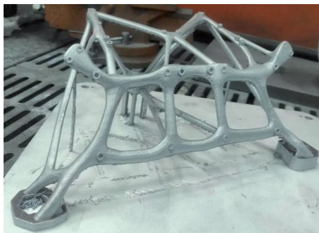
Рисунок 13 – Внешний вид образца после удаления материала поддержки
