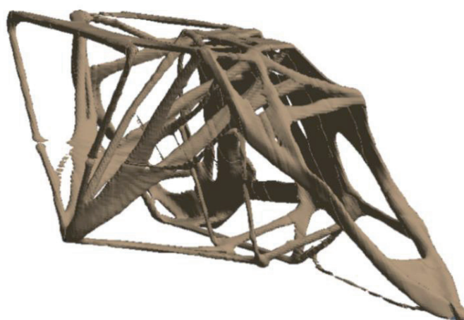
Рисунок 7 – Результаты топологической оптимизации второго приближения
