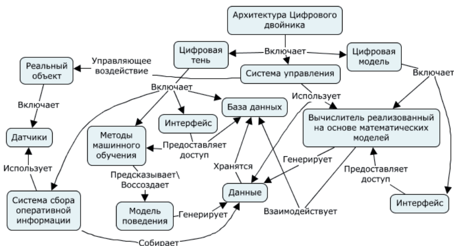
Рисунок 2 – Онтология архитектуры ЦД солнечной электростанции
