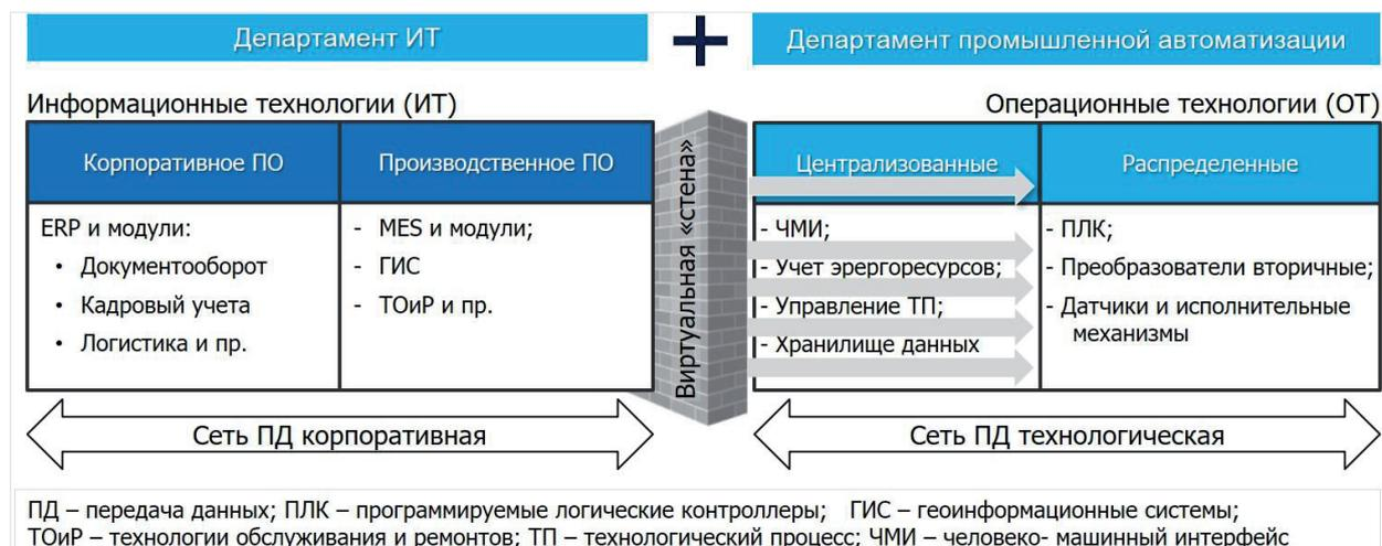
Рисунок 1 - Виртуальная функционально-технологическая «стена» между уровнями управленческой ОТ/ИТ-иерархии
