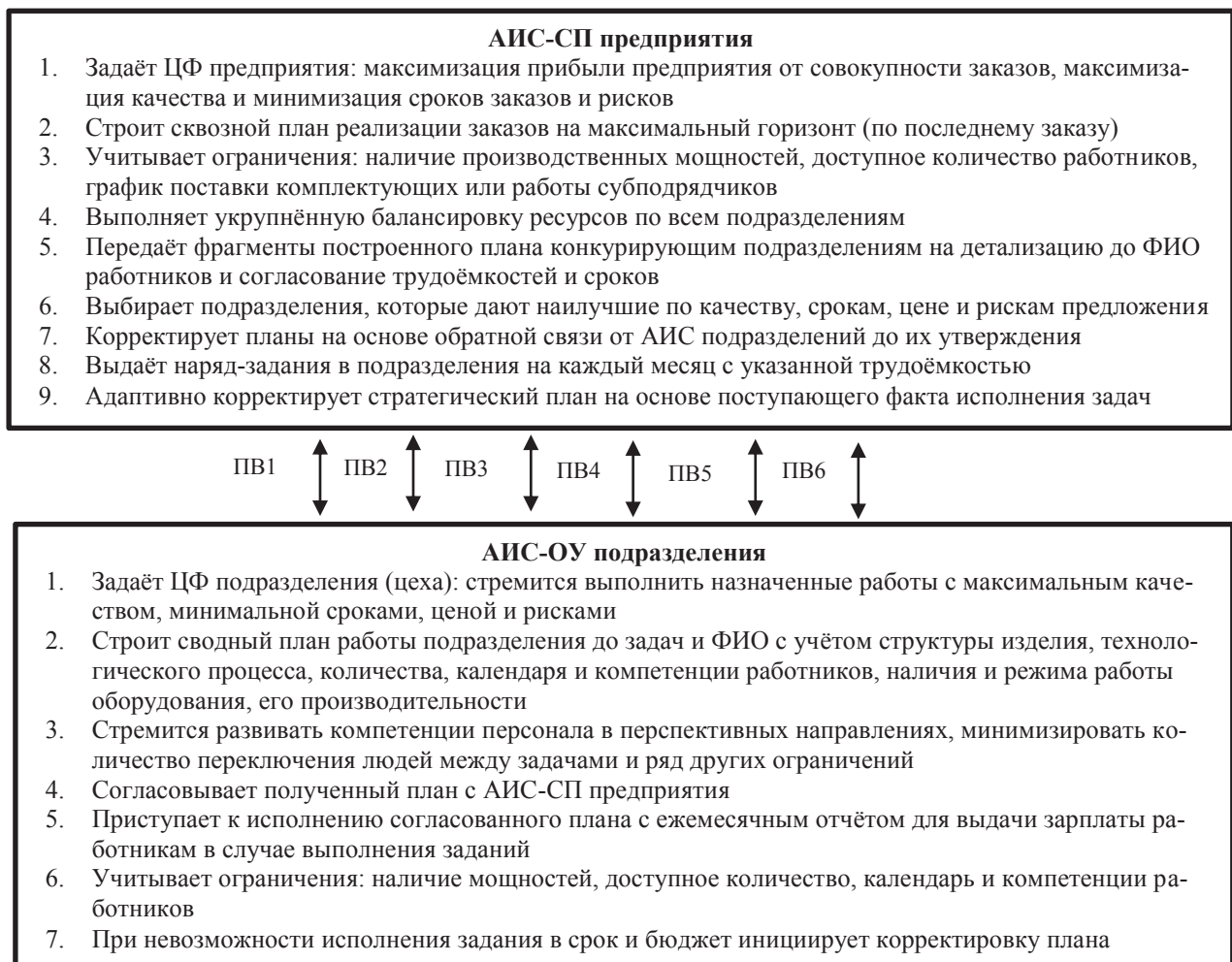
Рисунок 5 - Протоколы вертикальных взаимодействий АИС-СП и АИС-ОУ предприятия
