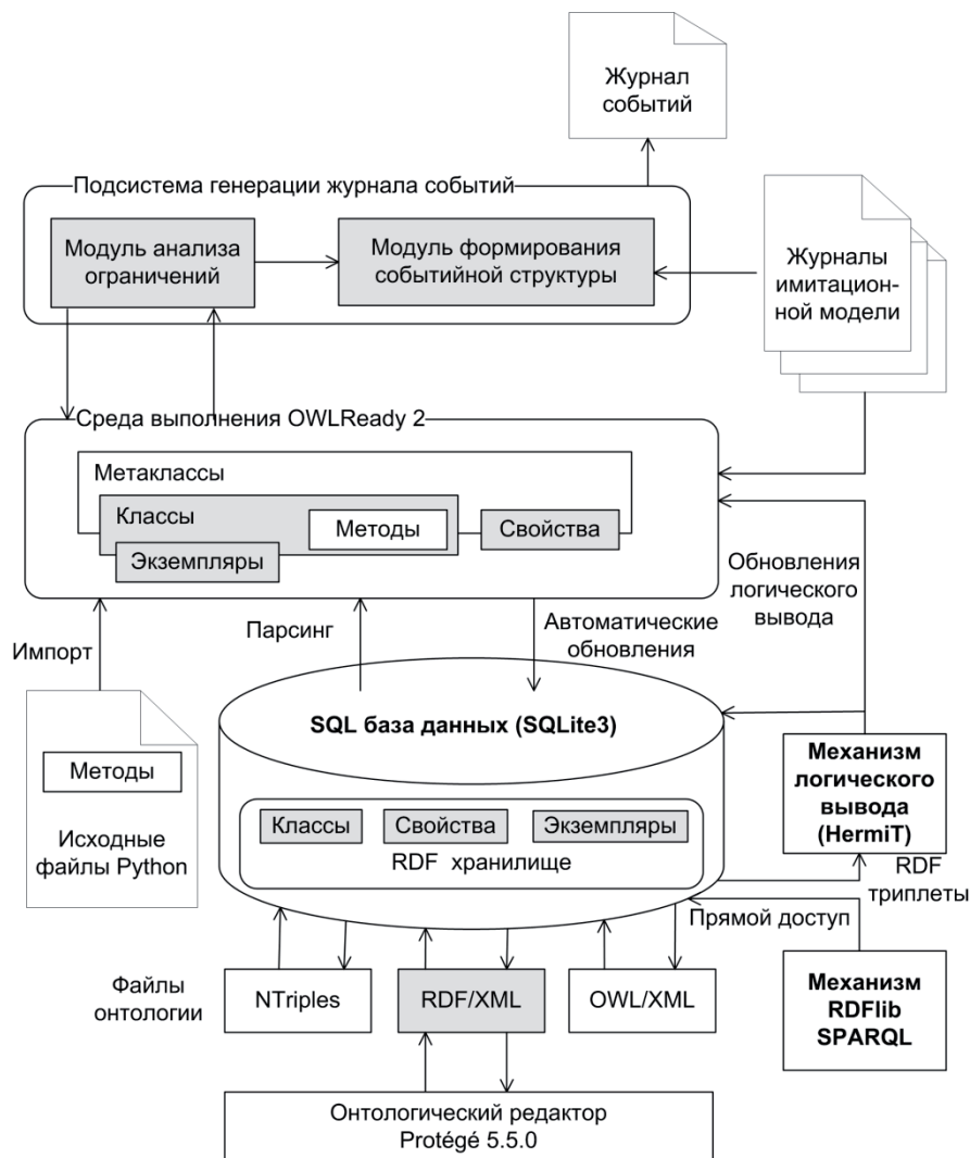
Рисунок 3 – Архитектура системы генерации событийных данных
