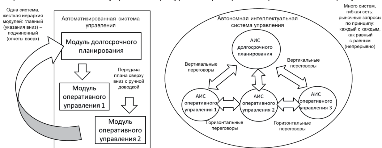
Рисунок 3 - Сопоставление каскадной (слева) и распределённой (справа) моделей управления ресурсами
