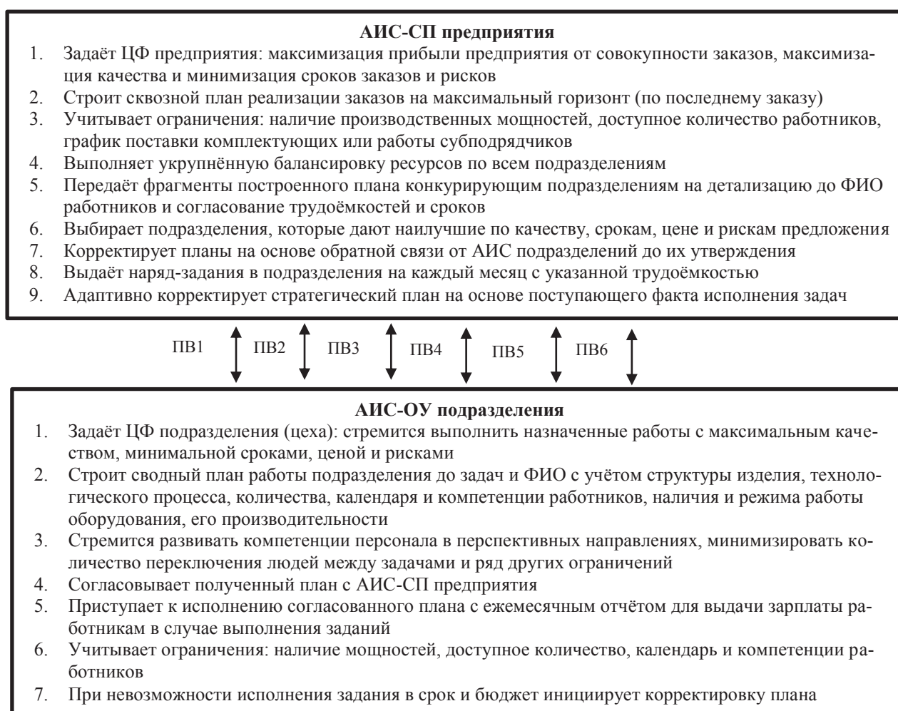
Рисунок 5 - Протоколы вертикальных взаимодействий АИС-СП и АИС-ОУ предприятия
