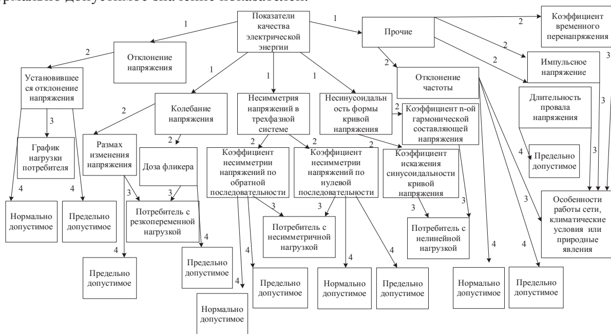
1 – группа показателей качества электроэнергии; 2 – вид показателя качества электроэнергии; 3 – причина отклонения значения показателей качества электроэнергии; 4 – вид нормы качества электроэнергии
