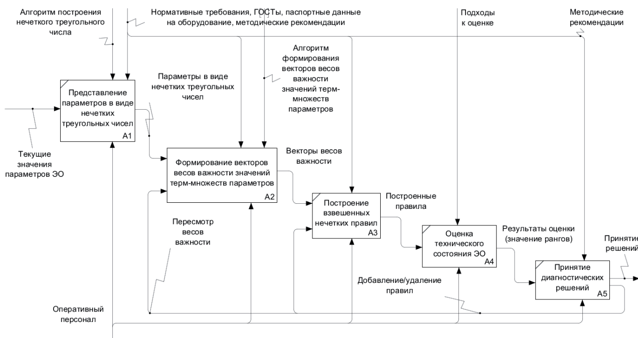
Рисунок 1 – Обобщённая схема оценки технического состояния электрооборудование в нотации IDEF0
