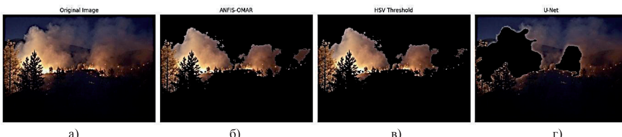
Рисунок 6 – Результаты эксперимента 4 изображение: а) оригинальное, б) сегментированное моделью ANFIS-OMAR , в) сегментированное методом HSV Threshold , г) сегментированное моделью U-Net
