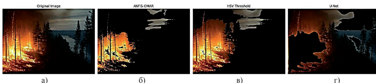
Рисунок 4 – Результаты эксперимента 2 изображение: а) оригинальное, б) сегментированное моделью ANFIS-OMAR , в) сегментированное методом HSV Threshold , г) сегментированное моделью U-Net
