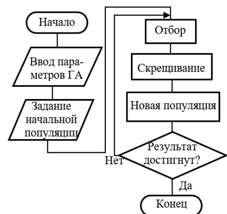
Рисунок 1 – Схема генетического алгоритма параметрического синтеза
