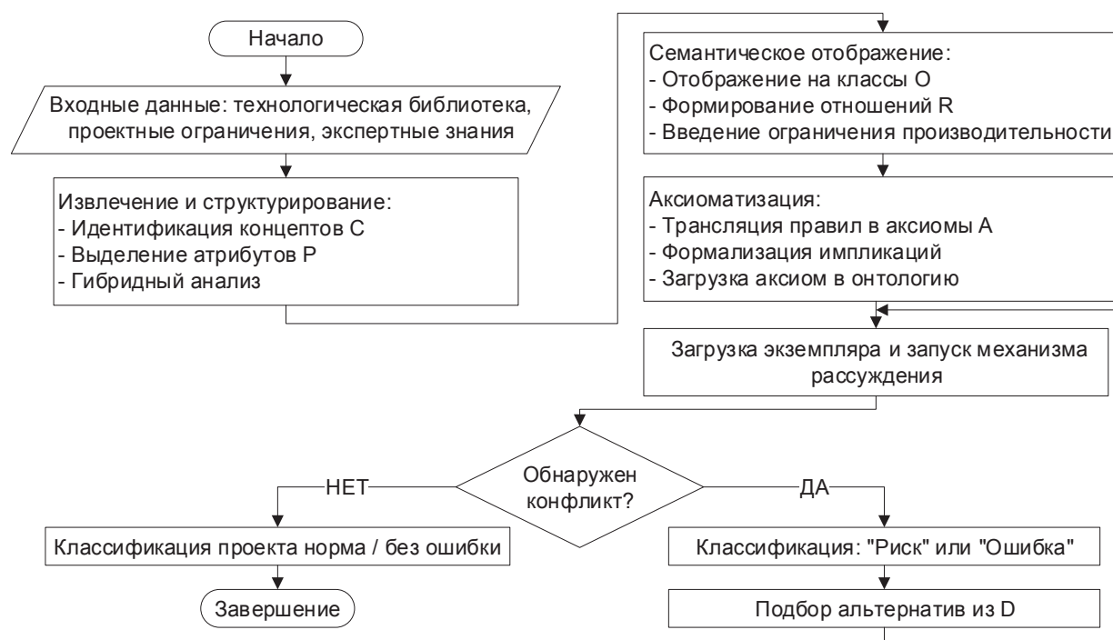
Рисунок 2 – Схема алгоритма формализации проектных знаний и поддержки принятия решений
